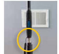
Für längere Luftstromanalysen an Wand- oder Deckenlüftungsöffnungen kann die EXP-64 auf ein Stativ geschraubt werden
