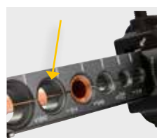
Lasergrafierte Sichtschablone zur Prüfung des Bördelflansches
